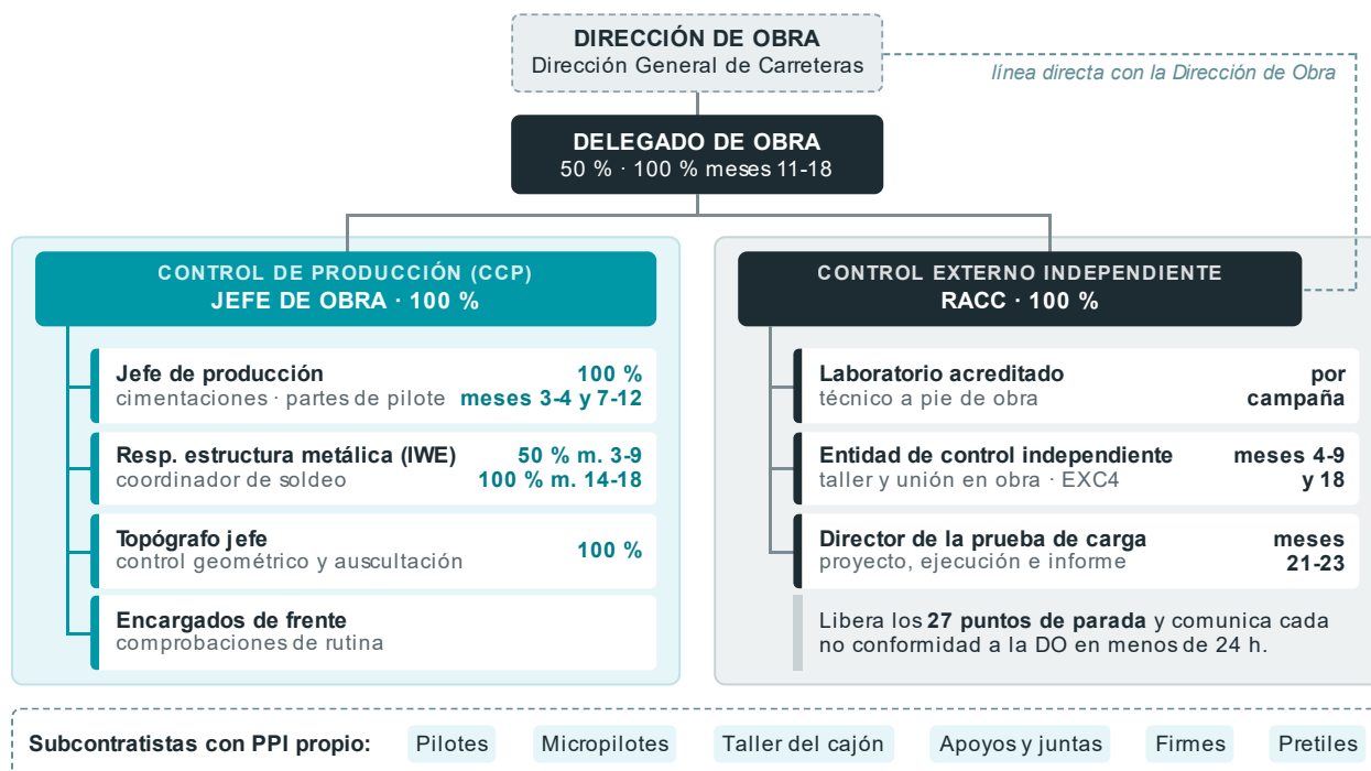
Figura 2.1. Organigrama del control de calidad. El control de producción depende del Jefe de obra; el control externo, independiente de producción, depende del RACC, con línea directa con la Dirección de Obra.
