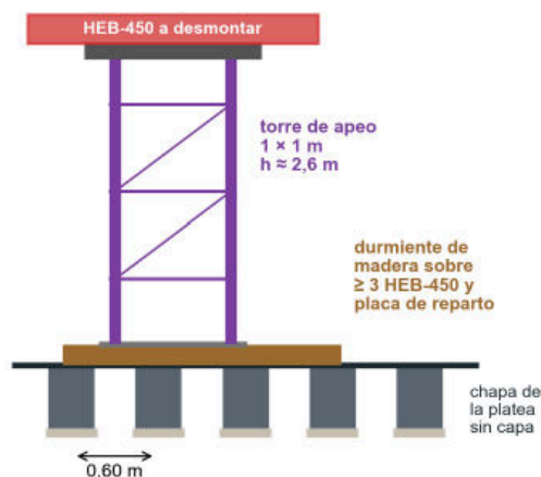
Figura 2.5. Torres de apeo sobre durmientes que reparten la carga en tres HEB-450 de la platea sin capa, y pie del andamio interior sobre la platea ya reforzada.
