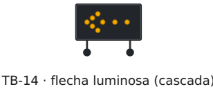
TB-14 · flecha luminosa (cascada)
