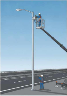
Sustitución de luminaria con camión cesta y corte de carril 8.3-IC
