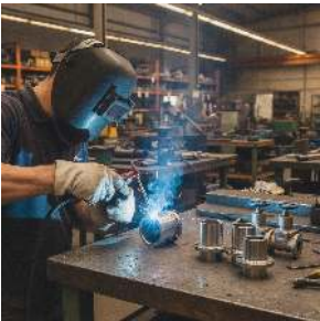
Premontaje en taller: spools AISI-304 con bridas y soldadura TIG con purga de argón; en cámara solo uniones de cierre
