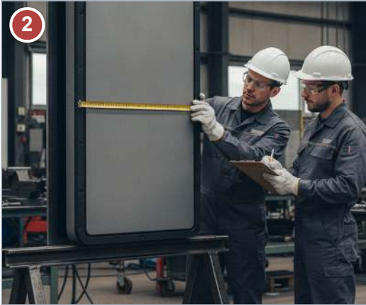
Fabricación en taller (ene-may 2027, fuera de ruta crítica): control dimensional, WPS/WPQR, VT+LP, prueba de junta en taller y pintura para inmersión (lm2).
