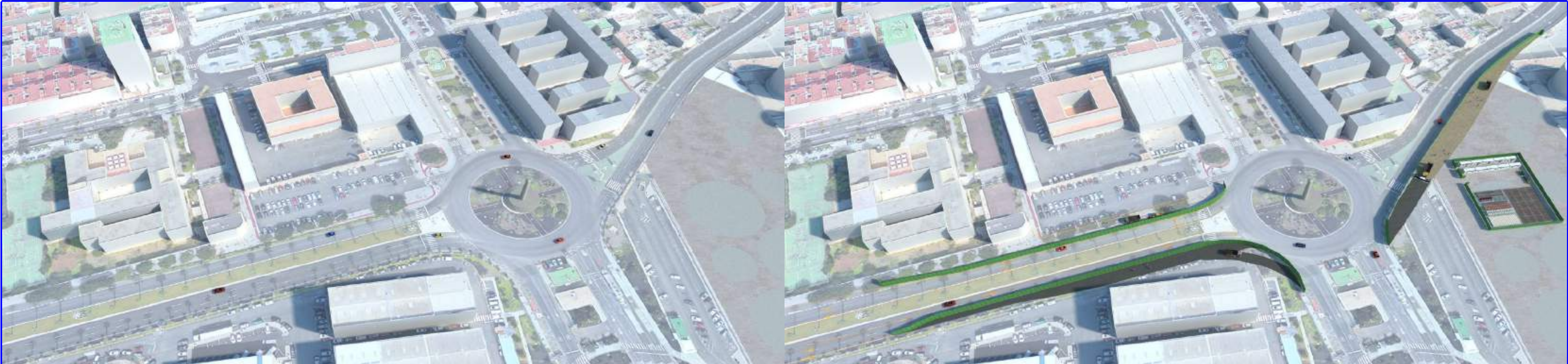
FASE 02: PILOTES ZONA OESTE, JET GROUTING, PRIMERA PUESTA DE LA LOSA SUPERIOR
