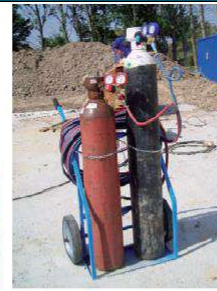
Equipo de soldadura y oxicorte.
