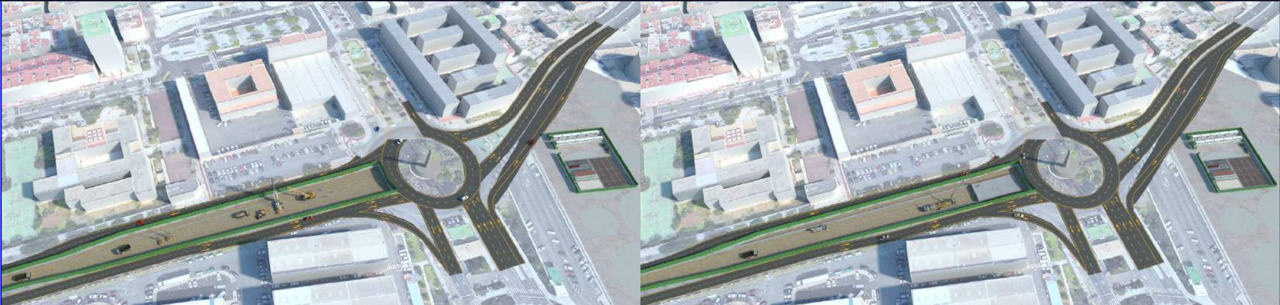
FASE 03: GLORIETA ELÍPTICA, PANTALLAS EN ZONA CENTRAL, TAPÓN DE JET Y 2ª PUESTA LOSA SUPERIOR
